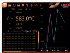
L'affichage du tableau indique les lectures instantanées, creuses, moyennes et de pics en plus de la température unique Meltmaster (sur le modèle 055 L).
