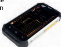
L'affichage du tableau indique les lectures instantanées, creuses, moyennes et de pics en plus de la température unique Meltmaster (sur le modèle 055 L).
