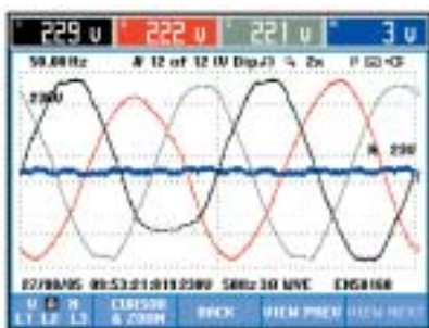
Figure 2 : formes d'onde du courant (en haut) et de la tension (en bas) sur toutes les phases au niveau du point de connexion situé avant le standard, montrant un pic de courant transitoire et les creux de tension consécutifs.
